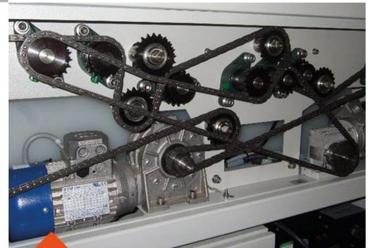
Système d'entraînement à chaîne robuste avec moteur A.C. et du moteur à brosse. Les roues libres sont équipées de roulements à billes scellés pour un fonctionnement sans entretien.
